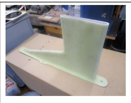
Das fertige Teil. Das Dreieck vorne wurde so vergrössert, das es bei gesenktem Schwert kein „Loch“ mehr im Lateralplan mehr gibt. Diese Verbesserung ist sogar regelkonform.
