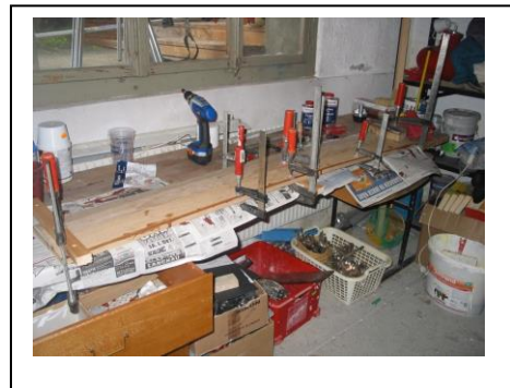
Da das Kielstück in ganzem Dicken nicht durchgebogen werden kann, wird es in zwei Teilen in der richtigen Biegung verklebt.
