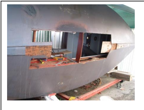
Das „Loch“ wird schlussendlich ziemlich gross. Ein Teil des Kiels muss ersetzt werden. Auf der rechten Seite ist schon die Schäftung für den Kiellersatz gemacht
