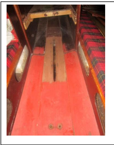
Le puits de dérive, le socle et la drisse ont été enlevés. L'image montre bien que la quille intérieure est en parfait état.
